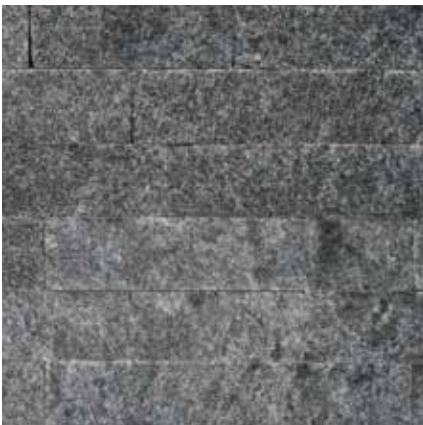
10104 390.00/t Leventina gespalten H 20 cm T 20 cm freie Längen 2 Ansichtsflächen gespalten, Lagerfugen gesägt auf Palett
