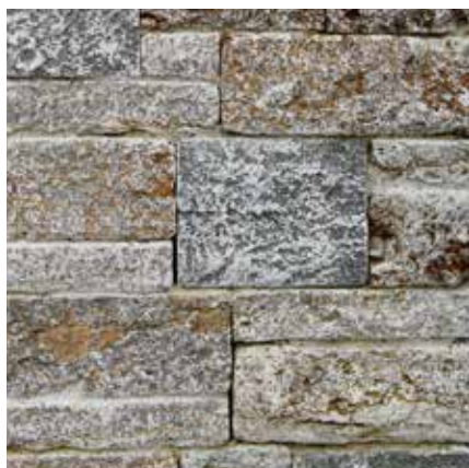
31921 434.00/m 2 Muschelkalk Burgmauerwerk H 7.5 / 15 / 22.5 cm T 20 cm L 20 – 60 cm 2 Ansichtflächen gespalten, Lagerfugen gesägt auf Palett
